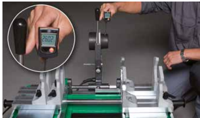
Měření teploty na mechanické svářečce
