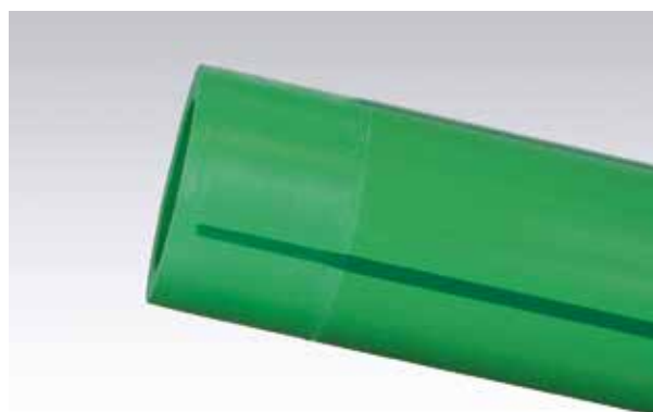
Svařovanou trubku opracujte - ořežte a očistěte čistícím ubrouskem.
