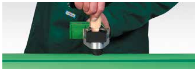
Vložení svářečky do stěny potrubí ...
