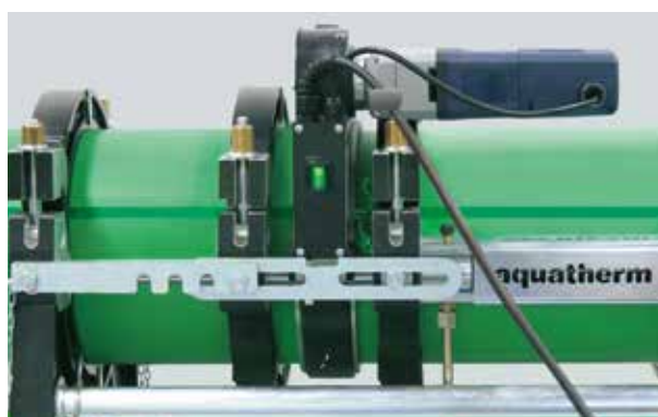
Upnutí svařovaných dílů, zarovnání a fixace
